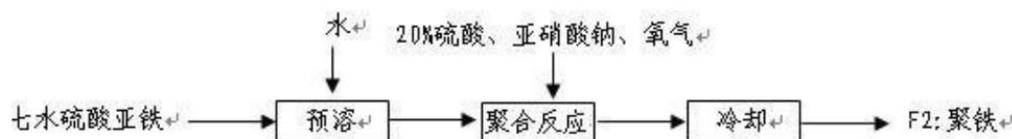
聚合硫酸铁工艺流程
